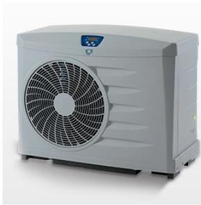
Pompa di calore aria/acqua monoblocco, adatta a piscine fino a 70 mc. Regolatore a display digitale, scambiatore condensatore ad acqua in titanio, sbrinamento automatico (inversione del ciclo), compressore rotativo a palette, fluido refrigerante R32, flussostato, sicurezza pressostato alta e bassa pressione, termostato antigelo (temperatura minima di funzionamento -5°C).
