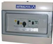
Quadro elettrico per idromassaggio con protezione della pompa, controllo fari e differenziale monofase. Composto da: contenitore stagno (IP65) 12 moduli, differenziale, protezione magnetotermica, contatto minimo livello, controllo manuale o automatico (pulsante pneumatico), uscita protetta controllo fari.
