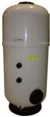
Filtri Artic ad alto rendimento, in resina di poliestere e fibra di vetro con finitura esterna in gel-coat. Altezza letto filtrante 1 m, pressione max di lavoro 2,5 kg/cm<sup>2</sup>. Temperatura max di lavoro 50°C. Rivestimento interno in gel-coat bianco.
